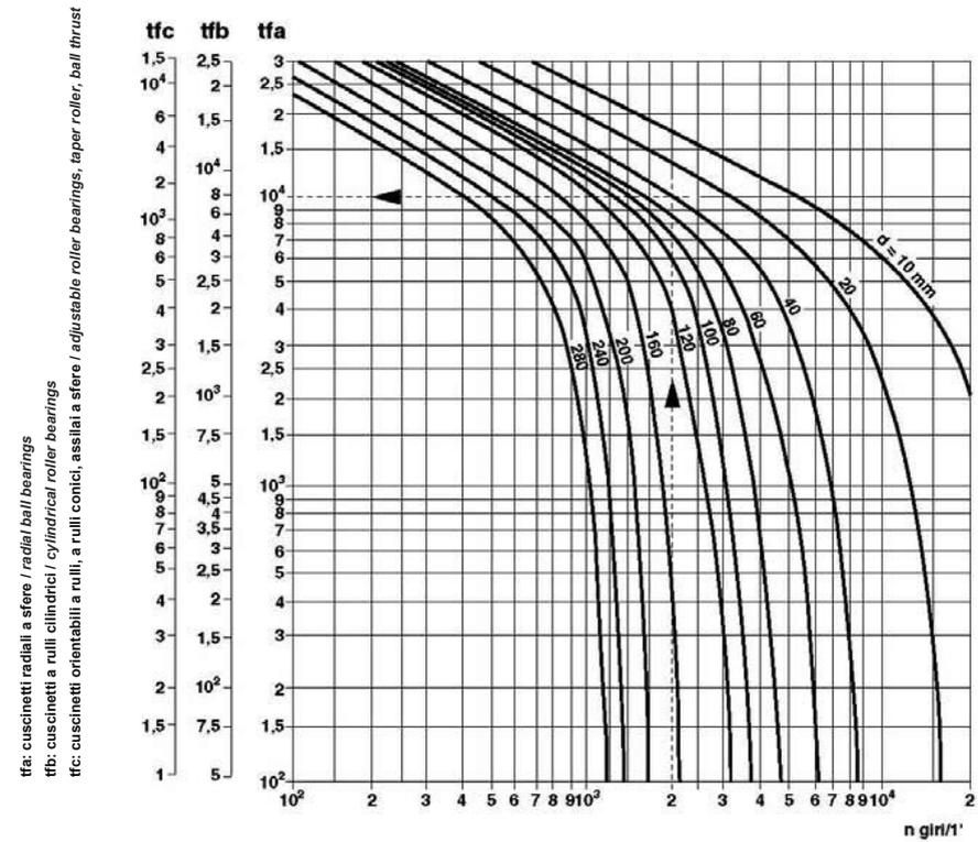
Esempio: un cuscinetto radiale a sfere, avente un diametro di foro (d) pari a 40mm, gira a 2000 giri/min (n). La temperatura di lavoro varia tra 60°C e 70°C. Si tracci una verticale a partire dal valore 2x10<sup>3</sup> sull'asse X del diagramma fino alla curva d=40mm. Dall'intersezione si tracci una orizzontale fino a incontrare l'asse Y relativo ai cuscinetti radiali a sfere (tfa); si ricaverà il valore 10<sup>4</sup> che rappresenta l'intervallo di lubrificazione in ore.
