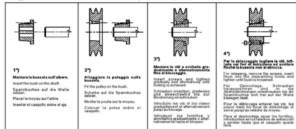
Montaggio reversibile - Reverse mounted - Reversierbar montiert - Montage reversible - Montaje reversible
