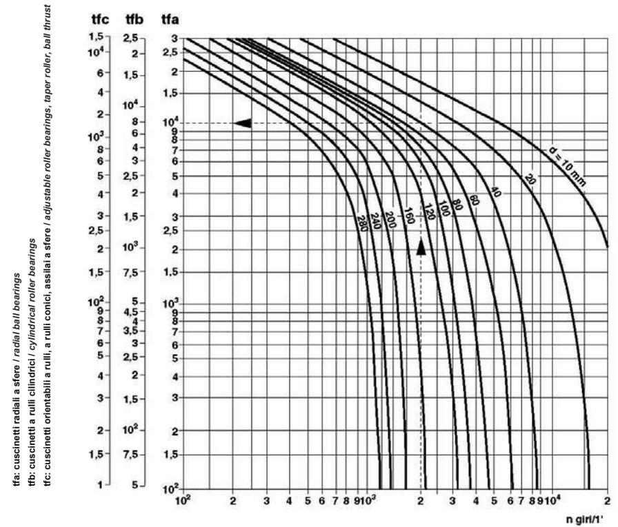
Esempio: un cuscinetto radiale a sfere, avente un diametro di foro (d) pari a 40mm, gira a 2000 giri/min (n). La temperatura di lavoro varia tra 60°C e 70°C. Si tracci una verticale a partire dal valore  $2 \times 10^3$  sull'asse X del diagramma fino alla curva d=40 mm. Dall'intersezione si tracci una orizzontale fino a incontrare l'asse Y relativo ai cuscinetti radiali a sfere (tfa); si ricaverà il valore  $10^4$  che rappresenta l'intervallo di lubrificazione in ore.
